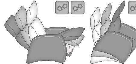
Individuelle Verstellung der Beinauflage, Rückenlehne und Aufstehhilfe durch drei Elektro-Motoren (max. 160kg).
