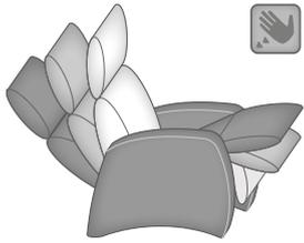
Verstellung der Beinauflage und Rückenlehne durch Körperdruck.
