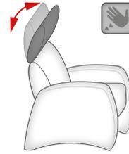
Alle Ausführungen sind generell mit einer manuellen Kopfpolsterverstellung über einen Rastbeschlag ausgestattet. So kann jede Relaxposition individuell verfeinert werden.
